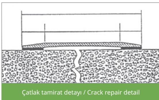
Çatlak tamirat detayı / Crack repair detail
