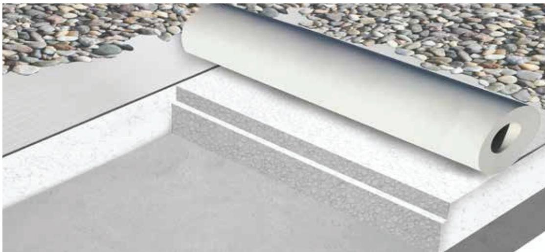
*Çakıl gibi bir balast malzemesinin kullanılması durumunda sentetik örtünün serbest serilmesi mümkün olmakta ve bu sayede delik delme - vida / raptet montajı gibi ekstra adım ve sarf malzemelerinden tasarruf edilmektedir.*
